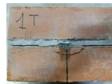
Essais de traction - Fissuration des maquettes avec l'attache plate
