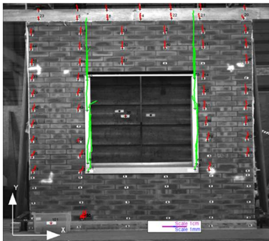
Attaches filaires, briques creuses
