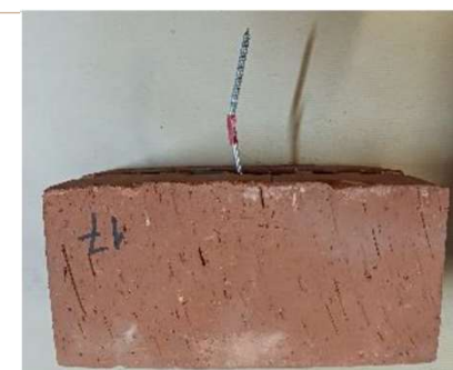
Essais de compression - Flambage de l'attache des maquettes avec l'attache filaire
