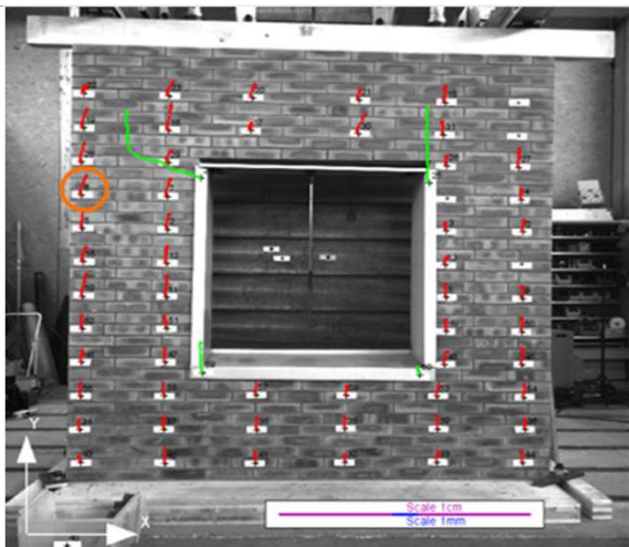
Essais de déformations différentielles
