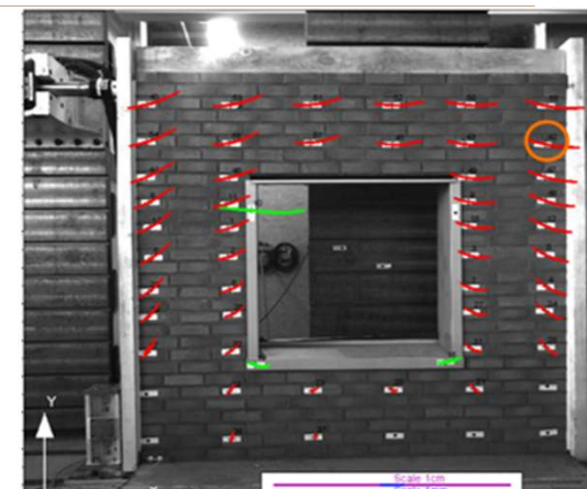
Essais cycliques – mise en parallélogramme
