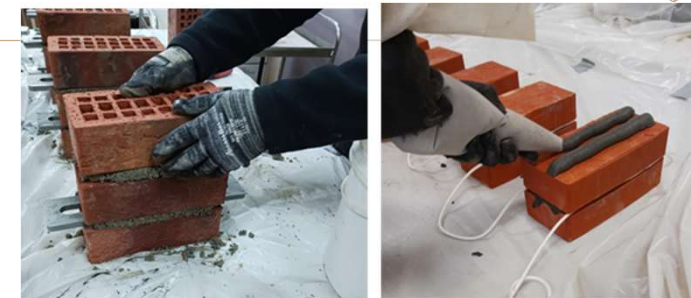
Eprouvettes pour l'essai de cisaillement
