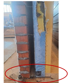
Essai de déformation verticale différentielle
