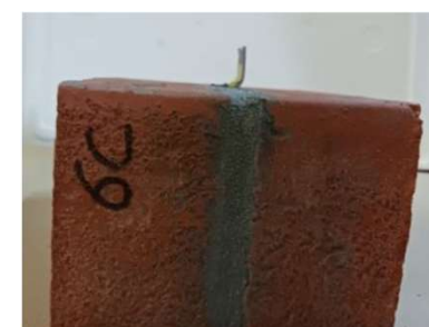
Essais de compression - Flambage de l'attache des maquettes
